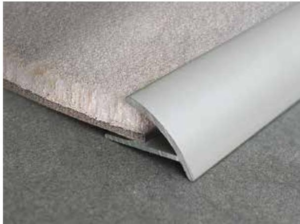
Profilés d'arrêt pour sols souples comme moquette et coco. En y appliquant une certaine pression, ces profilés se serrent et bloquent le revêtement textile d'une façon durable, en masquant les défauts de coupe et en préservant le bord.
